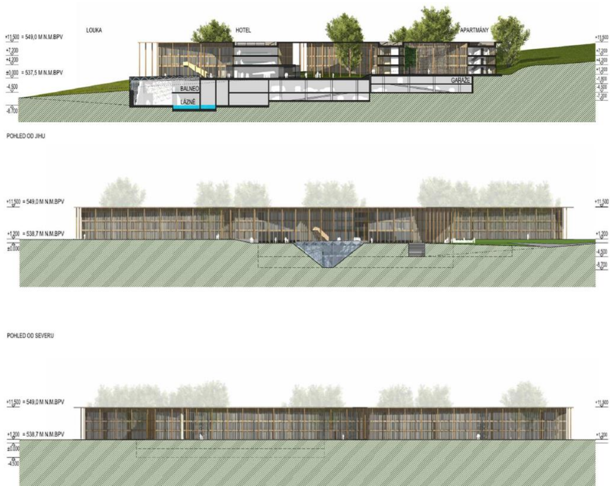
Obr. 7 – Podélné řezy nepravidelně uspořádaného lázeňského komplexu dokládají jednotnou výšku i architektonické řešení sjednocující působení celého areálu. Patrné je uspořádání podzemních podlaží pro lázně, balneo a podzemní garáže (vizualizace AP Atelier)
